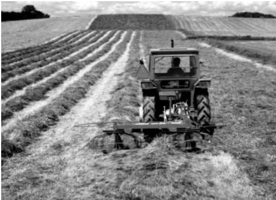
Figur 4.1 Med rotorvenderrive kan en spre, vende og samle høyet i løng. Foto: JF.
